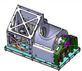
**SAPHIR** (Sondeur Atmosphérique du Profil d'Humidité Intertropicale par Radiométrie): 6 channels around the band of absorption of H2O at about 183.3 GHz 10 km resolution at nadir
