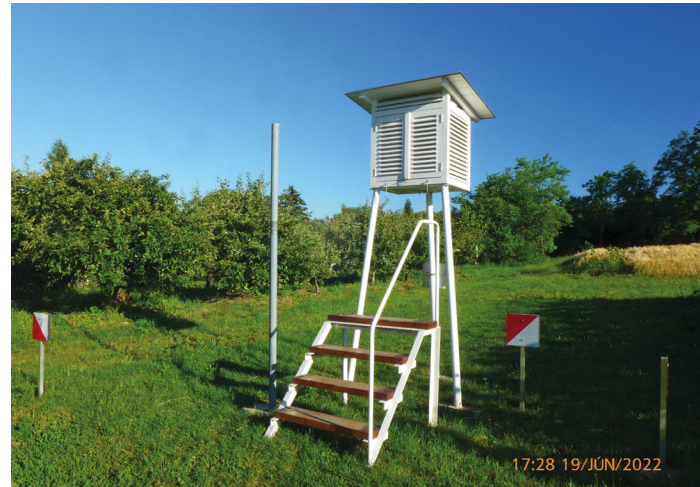
3. ábra. Stevenson-féle angol hőmérőház a mernyei állomás műszerkertjében.
